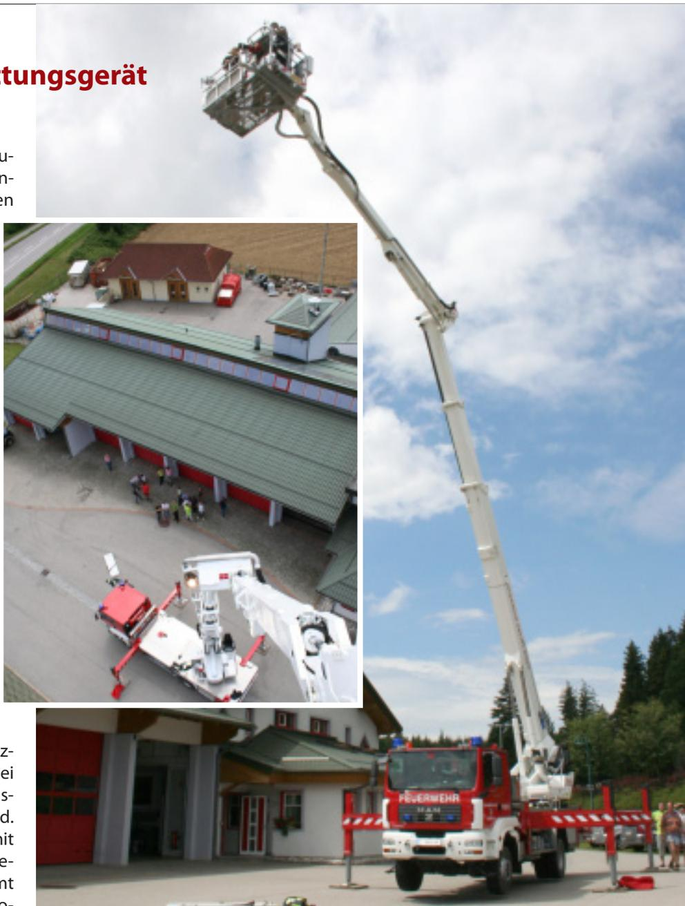
*Vorführung einer Teleskopmastbühne aus dem Hause „Bronto Skylift“. Der Korb fasst bis zu 500kg und bietet für eine Krankentrage oder Rollstuhl ausreichend Platz. Weiters ist ein Wasserwerfer fix montiert. Bei einer erreichbaren Arbeitshöhe von 32 m ist Höhenangst unangebracht.*
